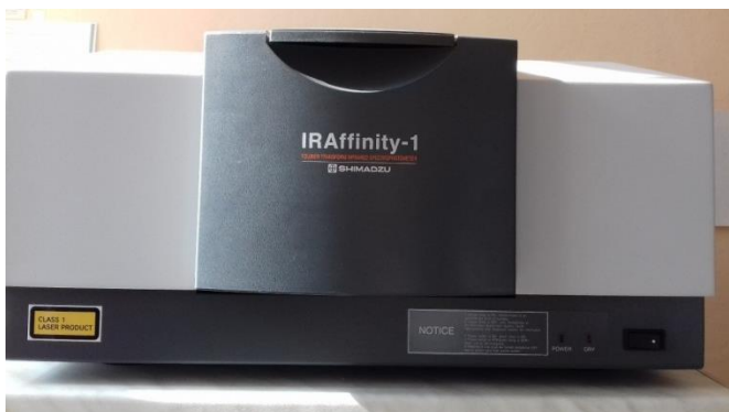
Рисунок 10 – Інфрачервоний спектрофотометр з перетворенням Фур'є IRAffinity-1 фірми SHIMADZU
