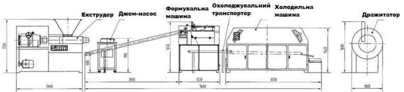
Рисунок 1.1 – Загальний вигляд технологічної лінії для виготовлення жувальної гумки
