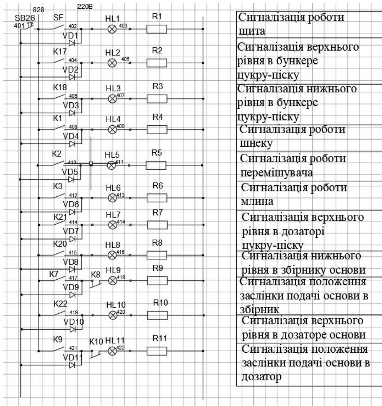
Рисунок 3.1 – Схема електрична принципова сигналізації технологічного процесу виготовлення жувальної гумки (початок)
