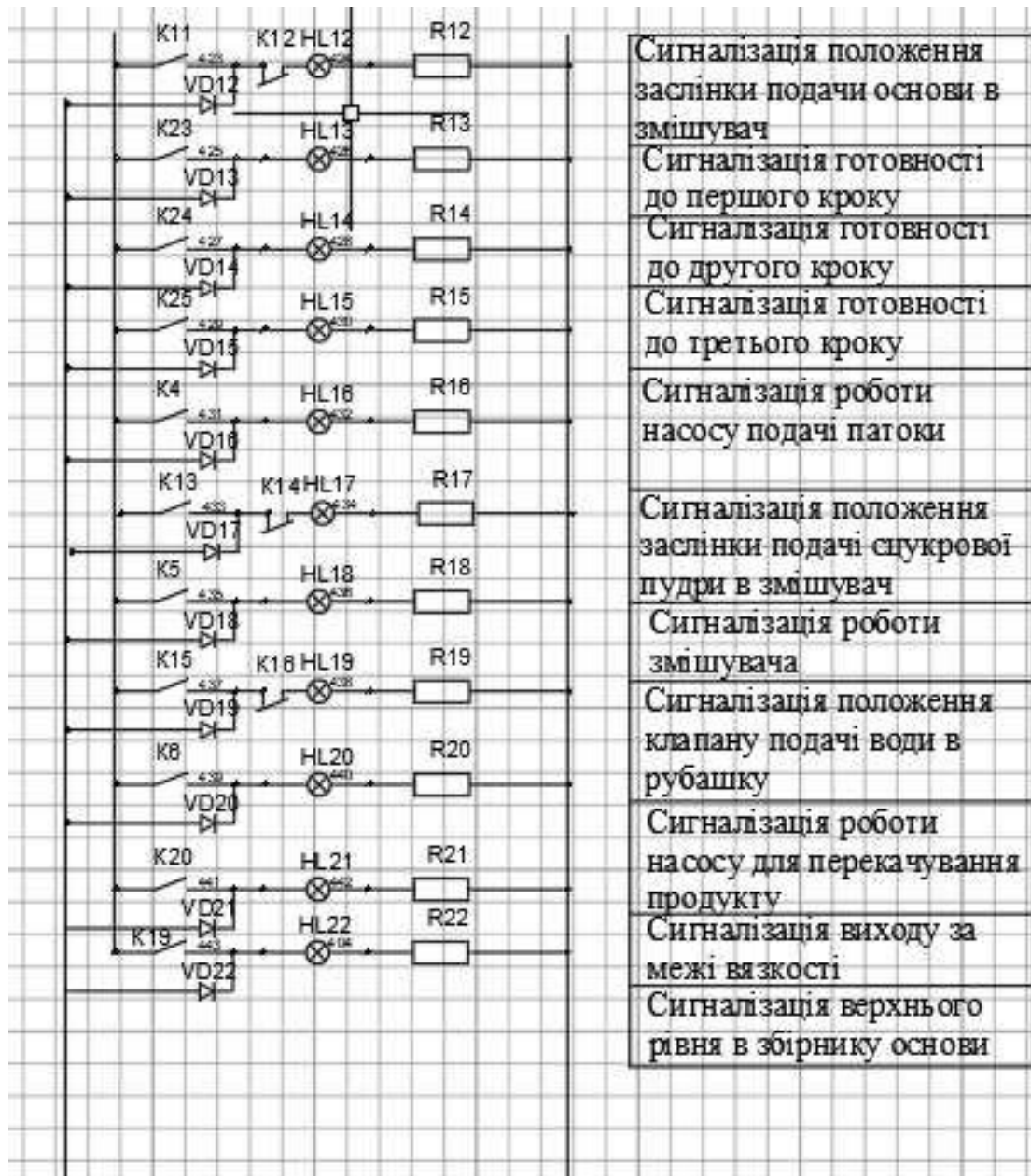
Рисунок 3.2 – Схема електрична принципова сигналізації технологічного процесу виготовлення жувальної гумки (завершення)
