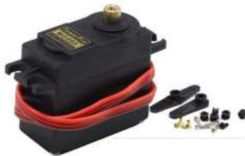
Рисунок 2.14 - Сервопривод Futaba T306 MG995
