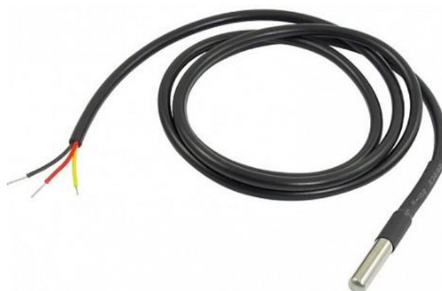
Рисунок 2.5 - Цифровий температурний сенсор DS18B20 в герметичному корпусі [96]
