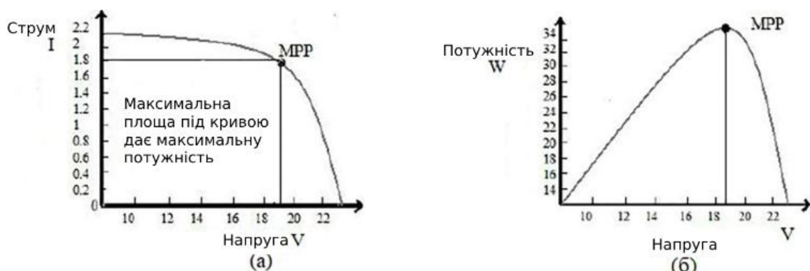
Рисунок 2.1 - Функції залежності струму від напруги та потужності від напруги
