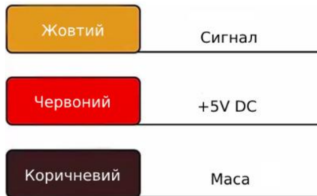
Рисунок 4.3 - Підключення SG90 до системи
