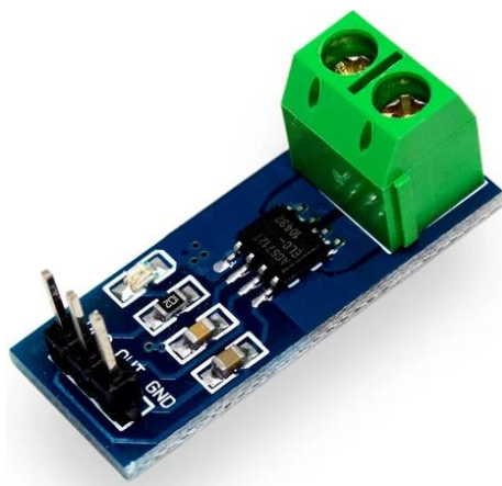
Рисунок 1.3 - Приклад безконтактного датчика струму на ефекті Холла (модуль ACS712) [83]
