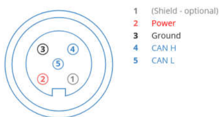
Рисунок 2.5 – Представлення інтерфейсу CANopen у вигляді 5-контактного промислового роз'єму M12
