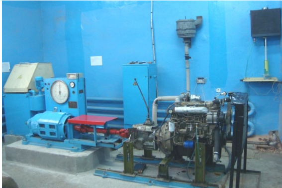
Рис. 1 – Загальний вигляд гальмівної установки з дизелем CY4102BZQ
