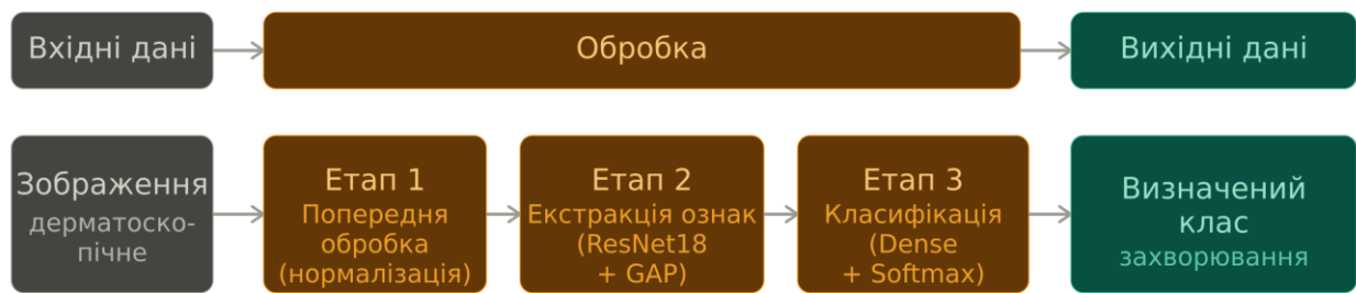
Рисунок 2.1 – Схема конвеєра обробки даних методу DermaNet
