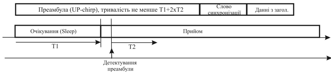
Рисунок 3.5 – Початок передачі сеансу зв'язку за допомогою передачі преамбули кадру LoRa
