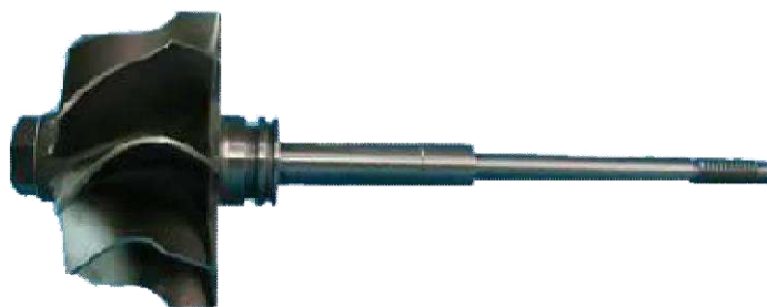
Рисунок 1.2. Загальний вигляд валу ротора турбокомпресора фірми Garrett GT2049S для двигуна 2.0 TDI DuraTorq автомобіля Ford Transit V
