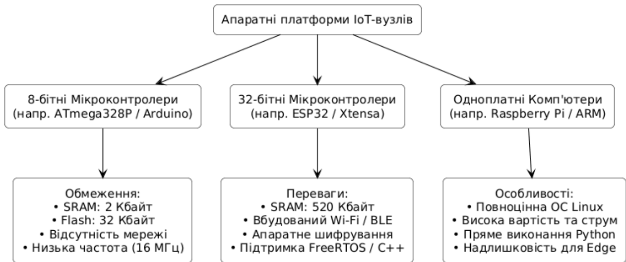
Рисунок 1.3 - Структурно-функціональний аналіз апаратних платформ для Інтернету речей
