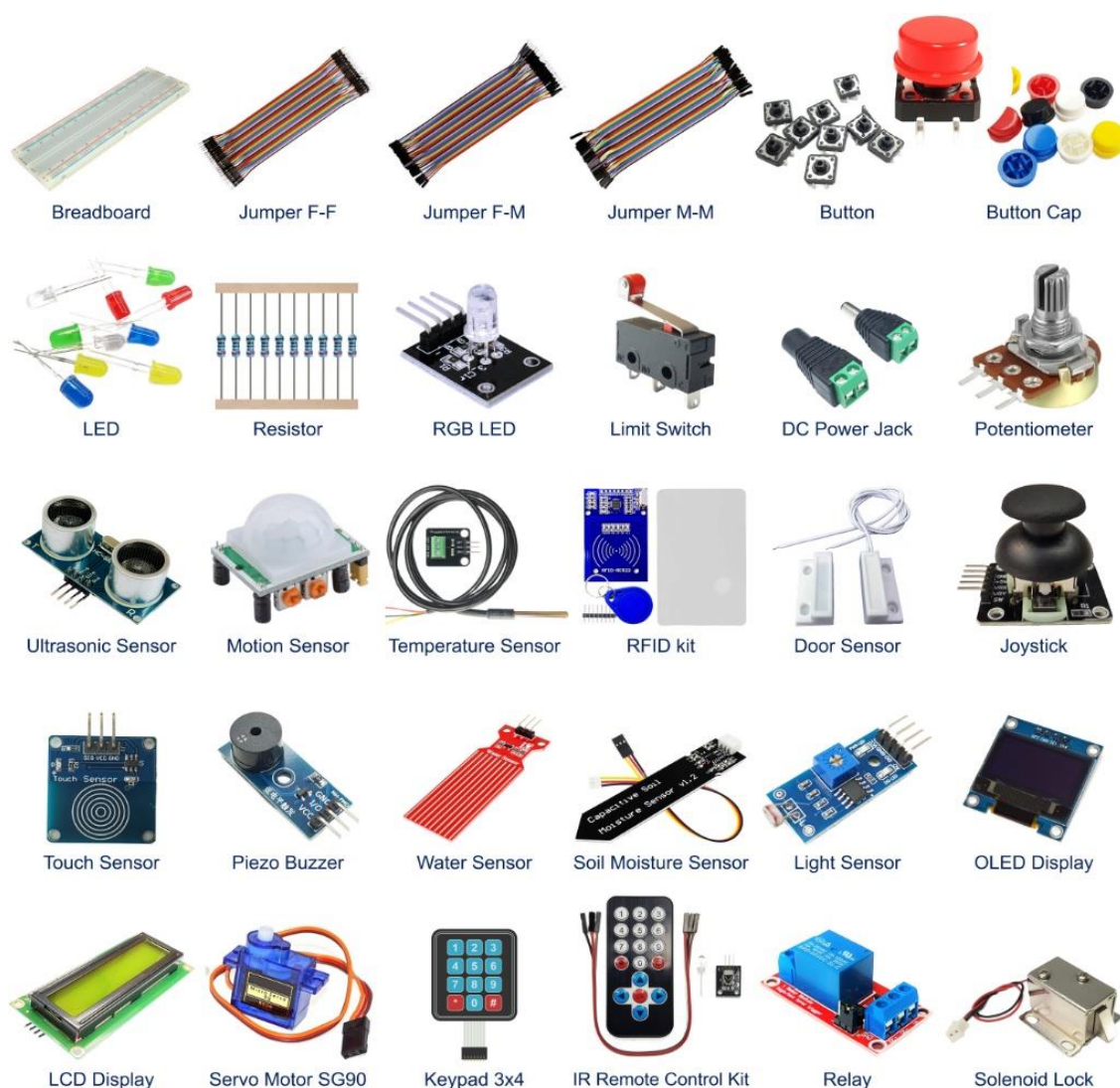
Рисунок 1.2 - Типовий набір датчиків, актуаторів та електронних компонентів для навчального стенду з Інтернету речей [48]
