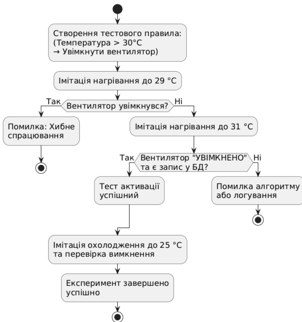
Рисунок 3.9 - Блок-схема проведення експериментального тестування логіки
