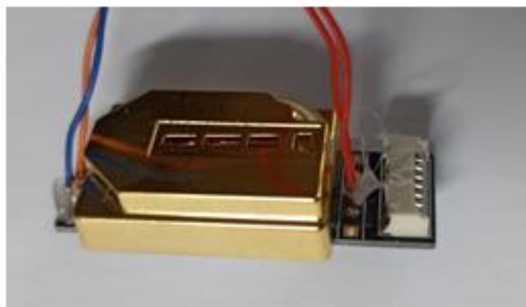
Рисунок 2.7 – МН-Z19В цифровий CO 2 -сенсор
