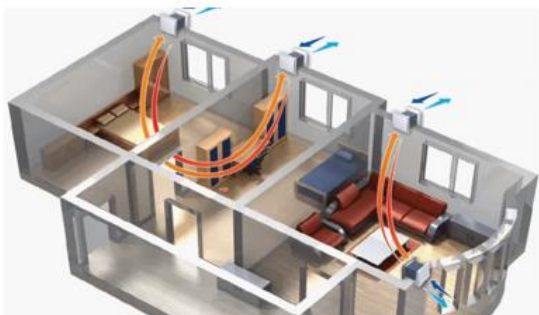
Рисунок 1.5 – Принцип роботи побутових рекуператорів
