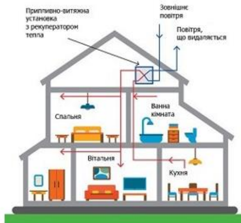
Рисунок 1.2 – Система вентиляції в будинку
