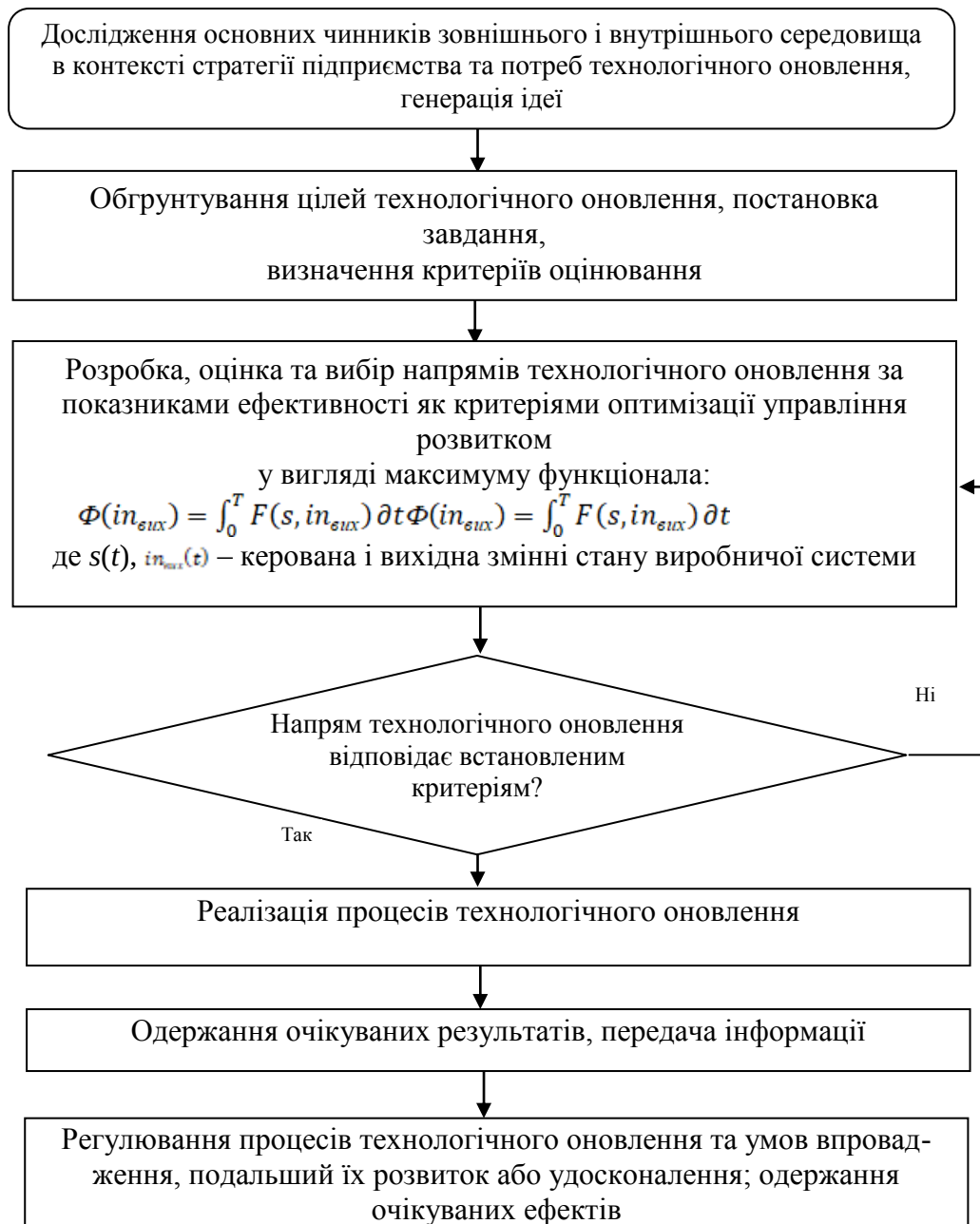
Рис. 4.6. Алгоритм взаємодії елементів системи управління технологічним оновленням підприємств машинобудування*
