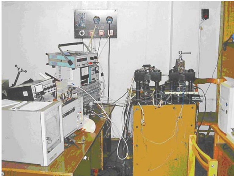
Рис. 1 Установка для дослідження матеріалів та покриттів в умовах фретинг - процесів
