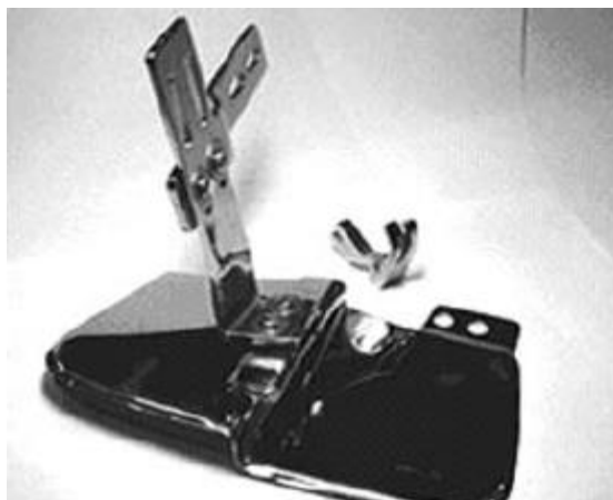
Рисунок 3.1 – Пристрій малої механізації для виготовлення складок на універсальній машині
