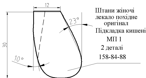
Рисунок 2.5 – Приклад побудови похідного лекала – підкладки кишені з відрізним бочком
