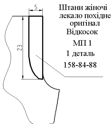
Рисунок 2.3 – Приклад побудови похідного лекала – відкоска
