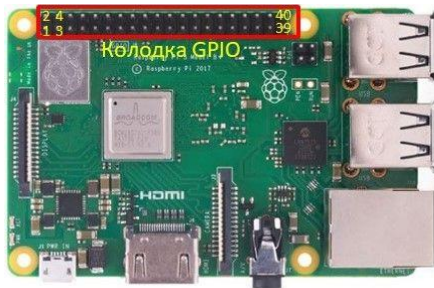
Рисунок 2.1 –Виводи GPIO на платі
