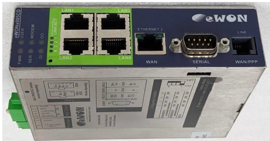
Рисунок 3.8 - Маршрутизатор eWON 4005CD від компанії eWON (Бельгія)
