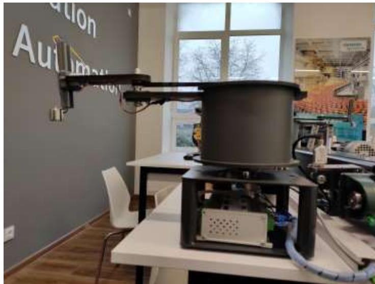
Рисунок 1.1 - Загальний вигляд маніпулятора із 6 ступенями свободи та електромагнітним ЗП
