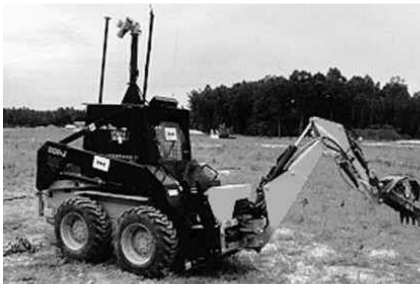
Рисунок 1.3 – Загальний вигляд транспортного засобу РС розмінування фірми ETODS виконаний на базі розвантажувача типу «BOBCAT» [15, 16]
