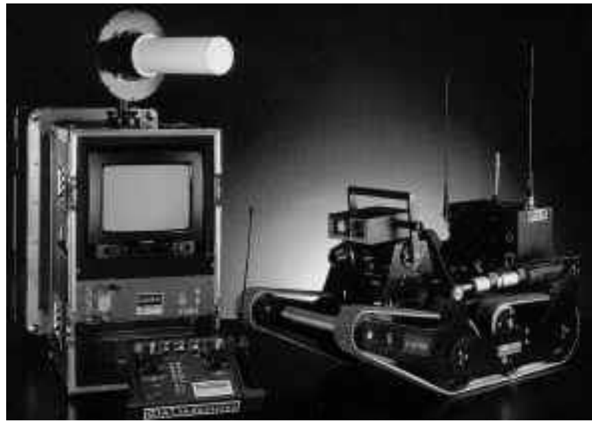
Рисунок 1.4 – Загальний вигляд АМР Castor фірми GIAT Industries, може бути оснащений або колісною або гусеничною ходовою частиною [15, 16]
