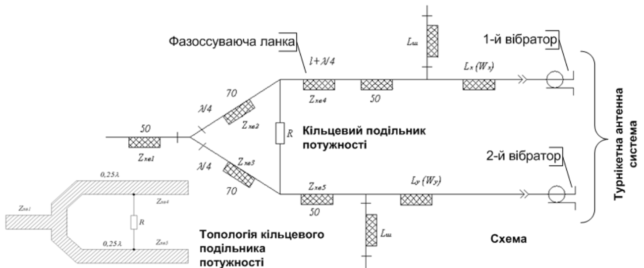
Рисунок 3.8 – Електрична схема живлення турнікетної антени і топологія (б) одноступінчатого кільцевого подільника потужності
