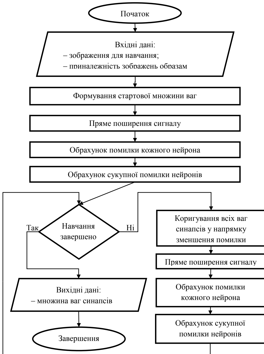
Рисунок 2.1 – Класичний алгоритм зворотного поширення помилки для реалізації навчання нейронної мережі перцептрон
