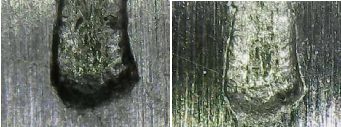
Рисунок 4.15 – Зображення поверхні тертя, виконані за допомогою електронного мікроскопа, зліва до експерименту, з права після
