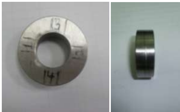
Рисунок 3.5 – Зразки – ролики для машини тертя П-5018
