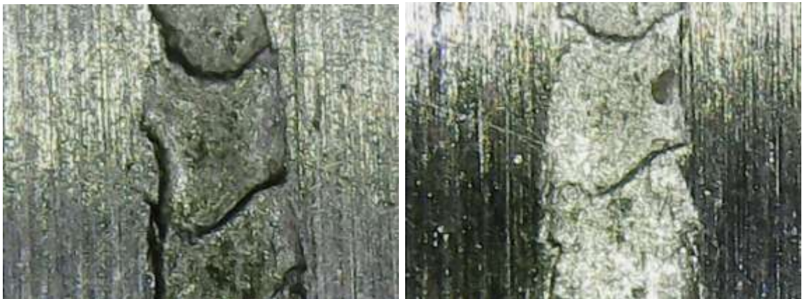
Рисунок 4.14 – Зображення поверхні тертя, виконані за допомогою електронного мікроскопа, до експерименту, після
