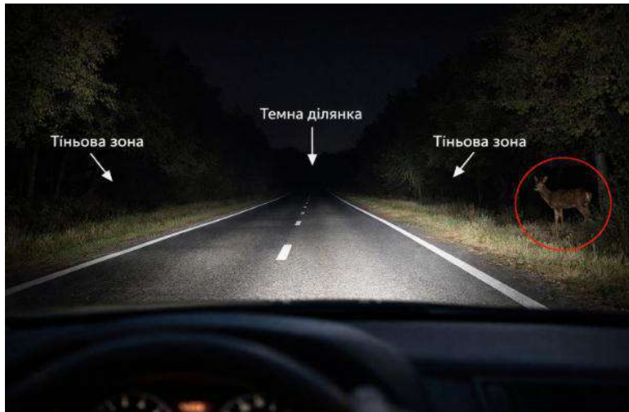
Рисунок 1.2 – Схема розподілу світлового потоку фар з утворенням тіньових та темних ділянок дороги
