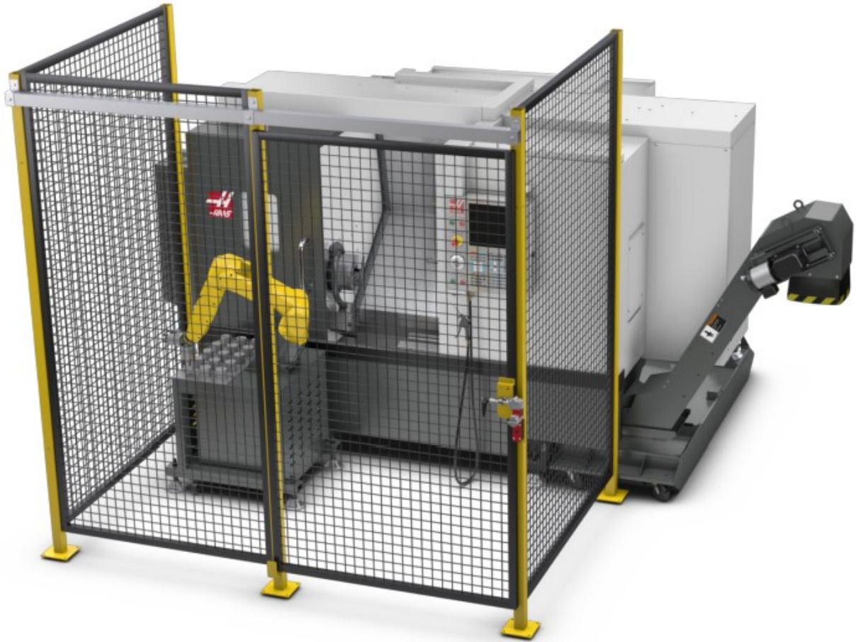
Рисунок 4.2 – Огорожа для безпечної роботи верстата з роботизованим пристроєм
