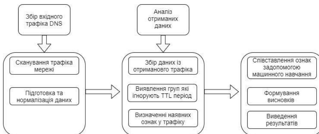
Рис. 1. Схема функціонування алгоритму виявлення бот-мережі, що використовує технологію «динамічна переадресація IP-адрес»
