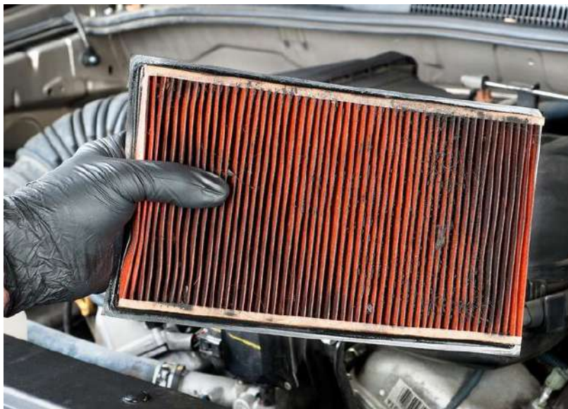
Рисунок 2.5-забитий повітряний фільтр
