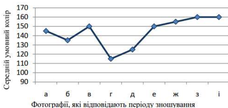
Рисунок 3.7-Середня умовна зміна кольору фотографії, що характеризує інтенсивність зношування поверхні в процесі тертя
