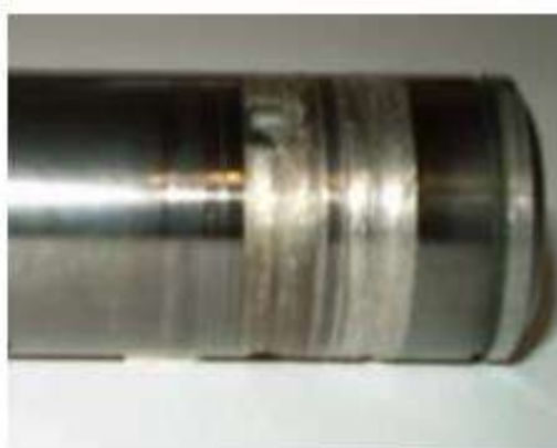
Рисунок 4.6-Ротор бензонасоса VRZ ZEXEL японського виробництва (пошкоджений через заклинювання прецизійної пари)
