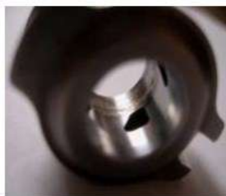
Рисунок 4.6-Ротор бензонасоса VRZ ZEXEL японського виробництва (пошкоджений через заклинювання прецизійної пари)
