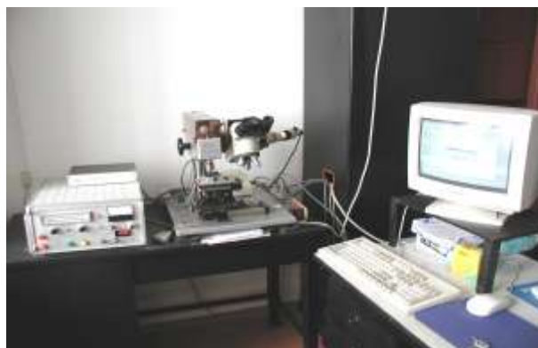
Rys. 4 – Widok zestawu REVETEST do pomiarów przyczepności
