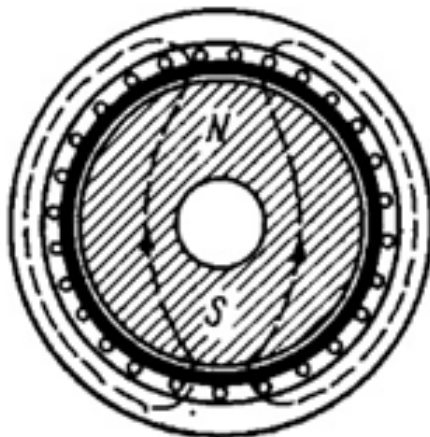
Рисунок 1.6 – Будова магнітної системи двигуна постійного струму з циліндричним магнітом всередині
