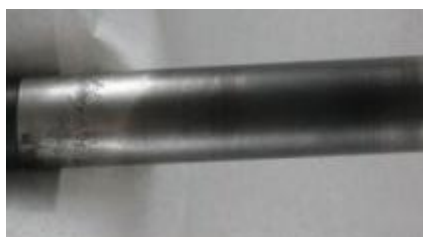
Рисунок 1.11. Патологічний знос напрямної частини стержня впускного клапана з боку головки
