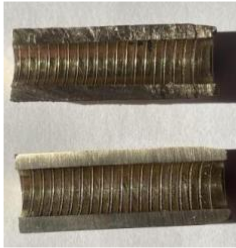
Рисунок 4.25 – Спіральні маслоутримувальні канавки напрямної втулки клапана
