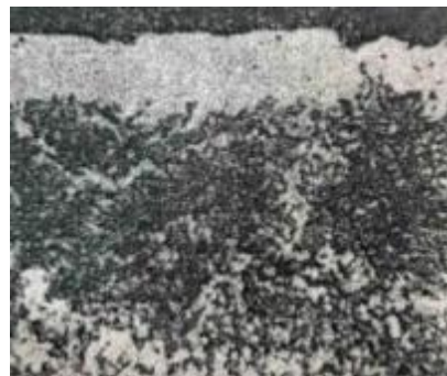
Рисунок 5.9 – Мікроструктура плазового покриття після нанесення
