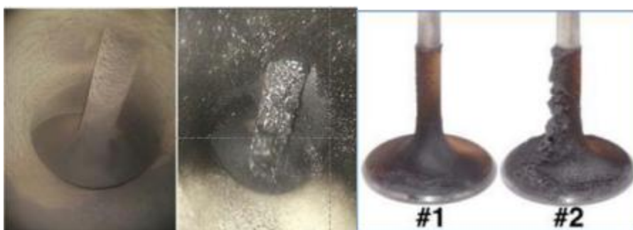
Рисунок 1.9. Відкладення на впускних клапанах
