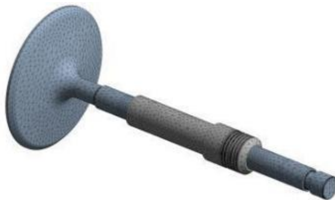
Рисунок 4.3 – МКЕ-сітка клапана з напрямною (Ansys Coupled Field Static)
