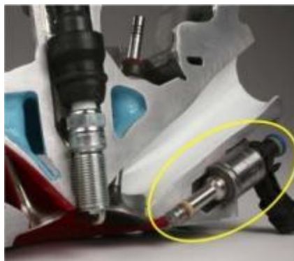
Рисунок 1.8. Система прямого впорскування палива
