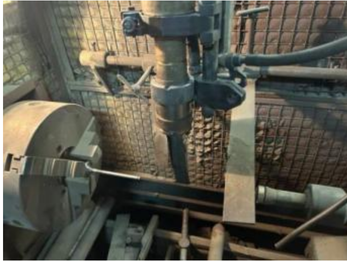
Рисунок 5.2 – Встановлення клапана для плазмово-дугового нанесення покриттів
