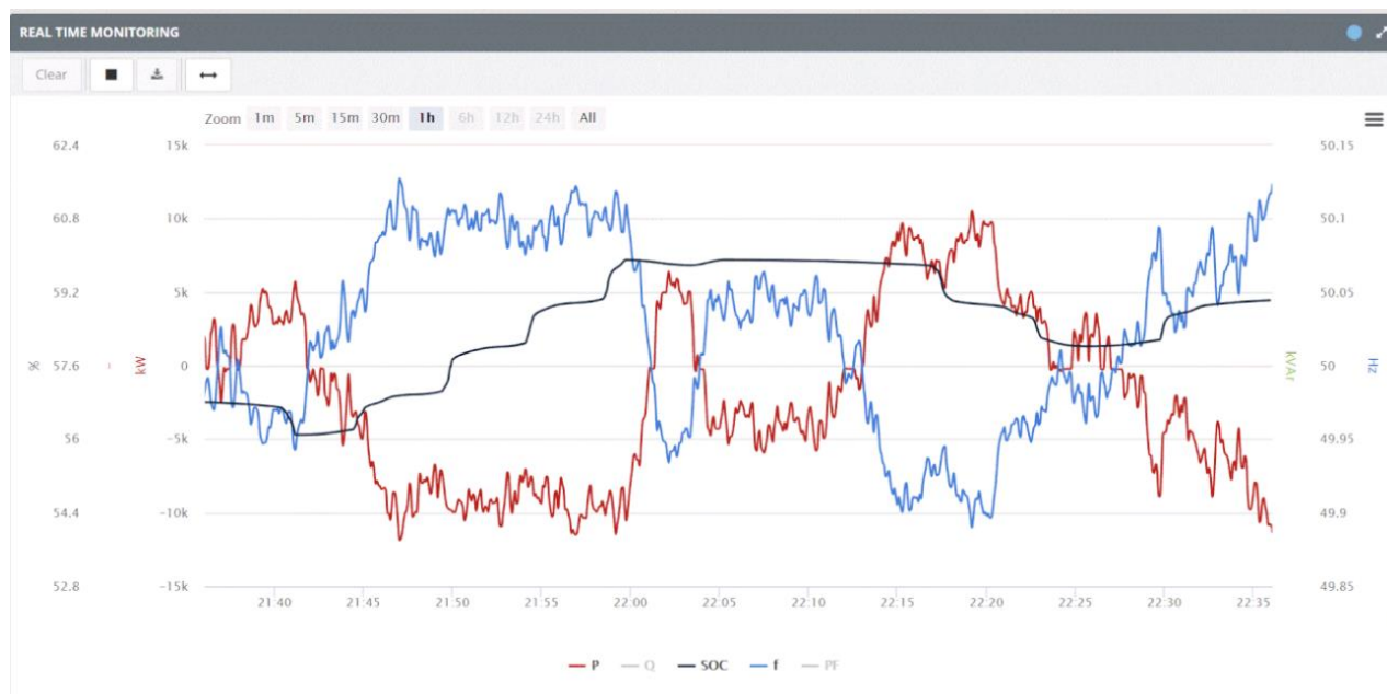
Рисунок 3.4 – Залежність режиму заряду та розряду системи накопичення енергії від змін частоти мережі
