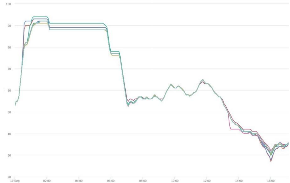
Рисунок 3.5 – Зміна рівня заряду акумуляторних батарей під час роботи системи підтримки частоти електромережі
