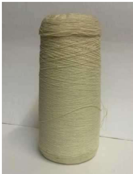
Рисунок 1.7 - Утворення нерівномірної щільності, як по осі, так і по радіусу намотування
