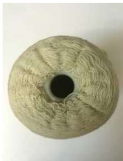
Рисунок 1.4 - Зниження натягу нитки у внутрішніх шарах повністю напрацьованого пакування
