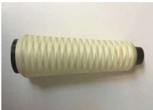
Рисунок 1.6 - Утворення ущільнених шарів по всій довжині пакування (стрічкове й джгутове намотування)
