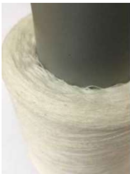
Рисунок 1.4 - Зниження натягу нитки у внутрішніх шарах повністю напрацьованого пакування
