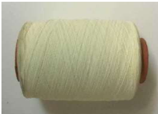
Рисунок 1.3 - Розташування крайніх витків на плоских торцях пакування по прямим лініях (хордах)
