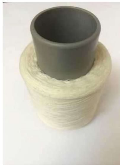
Рисунок 1.7 - Утворення нерівномірної щільності, як по осі, так і по радіусу намотування
