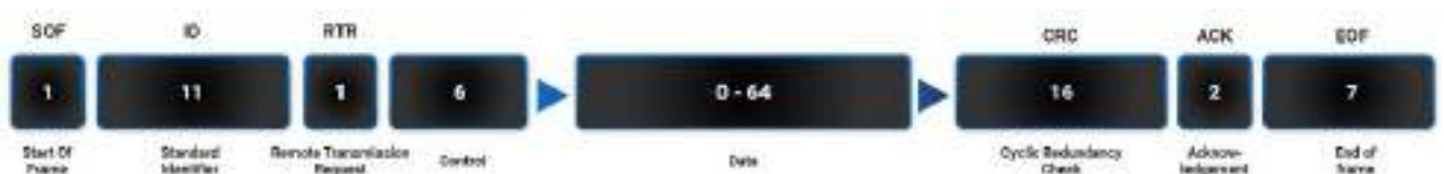
Рисунок 3.10 – Структура стандартного CAN-повідомлення [36]
