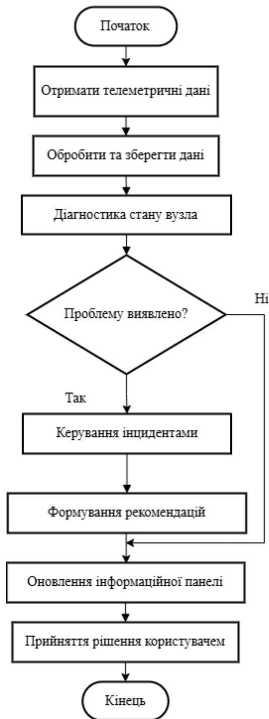
Рисунок. 3.11 – Блок-схема обробки телеметричних даних та формування рекомендацій
