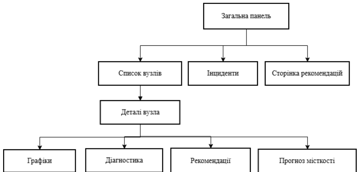
Рисунок. 3.4 – Структура користувацького вебінтерфейсу системи
