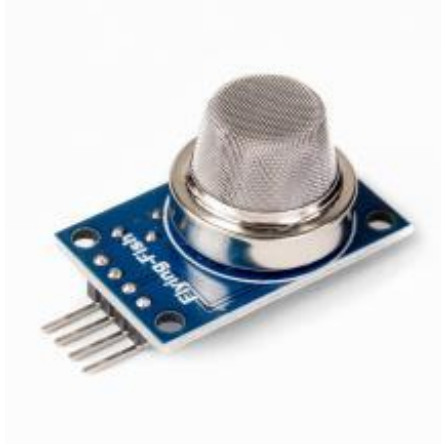
Рисунок 2.4 — Давач диму і газу MQ-2
