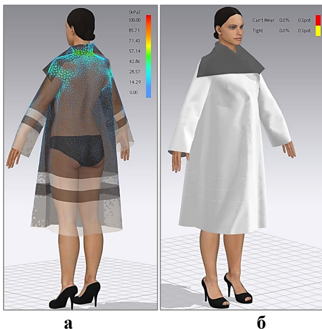
Рисунок 2.10 – Якість посадки моделі головного виробу розробленого в Clo 3D: а)карта напруги; б)карта проблемних зон
