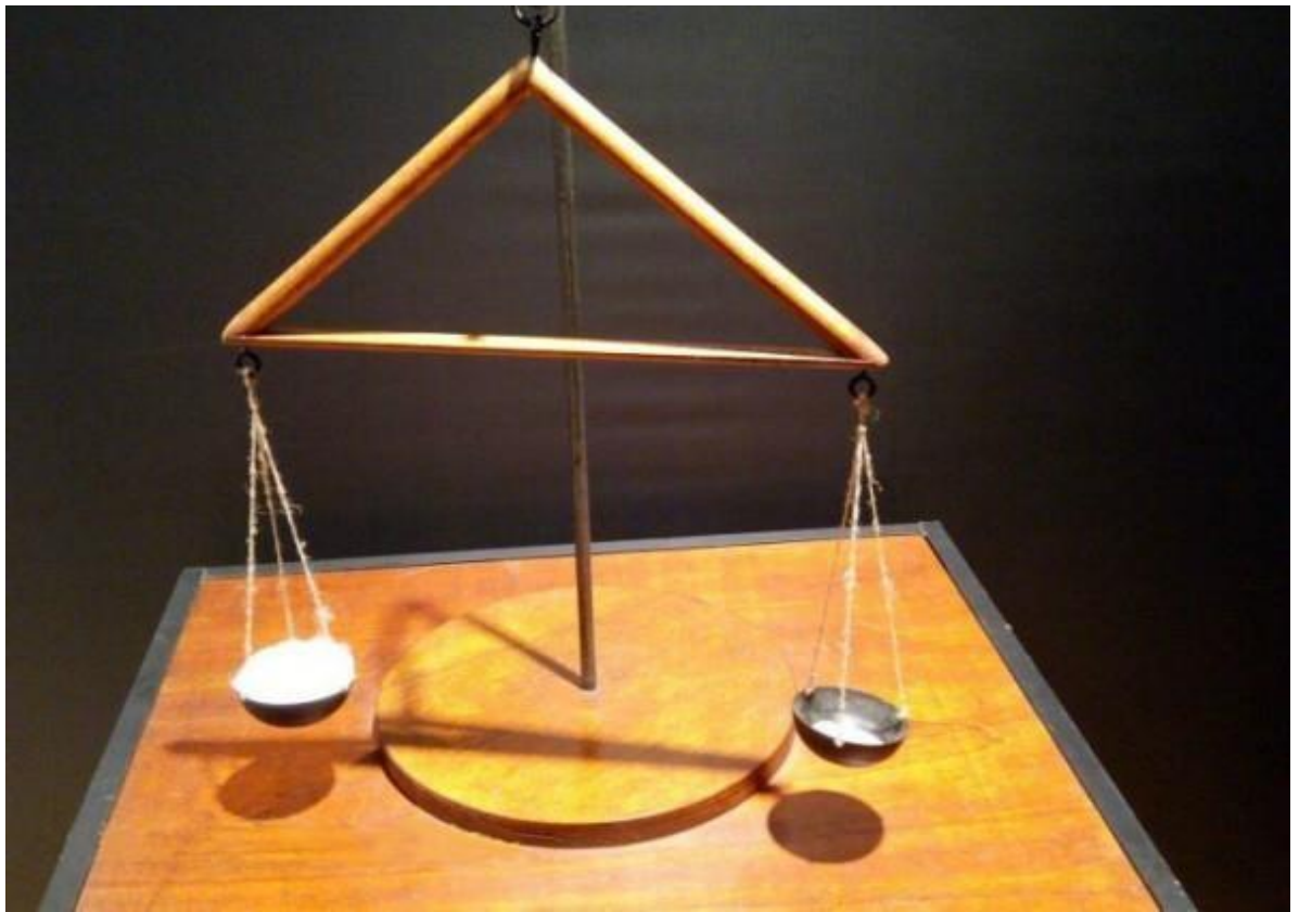
Рисунок 1.8 - Гігрометр Леонардо да Вінчі
