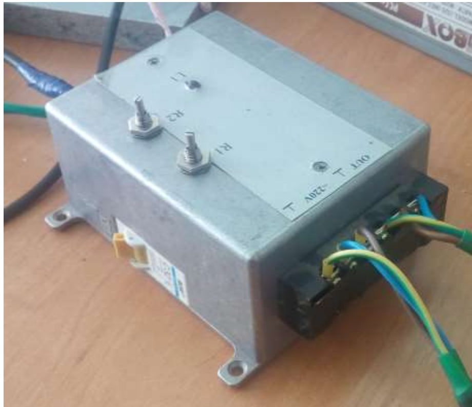
Рисунок 3.15 – Фото розробленого пристрою живлення та керування ЛЕМД
