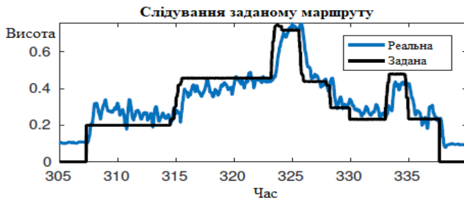
Рис. 9 Вимірjana висота при дотриманні заданої висоти за допомогою LQ регулятора
