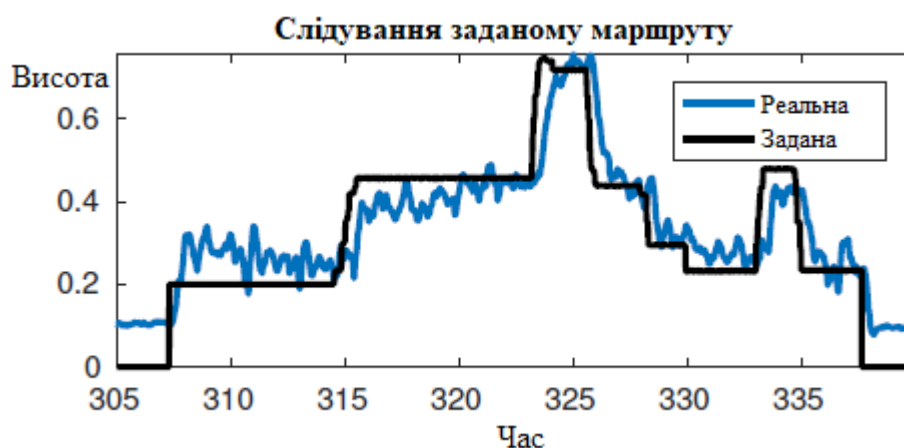
Рис. 4.7 – Виміряна висота при дотриманні заданої висоти за допомогою лінійно-квадратурним керуванням та регулюванняма. Кути нахилу регулювалися вручну, щоб підтримувати постійне положення.
