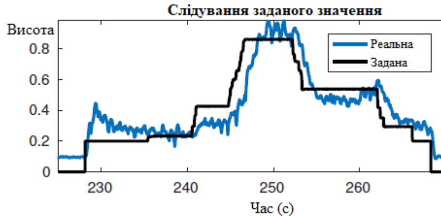
Рис. 4.4 – Виміряна висота при дотриманні якої використовують пропорційно-інтегровано-диференційного регулятора, кути нахилу безпелотного літального апарата регулювалися вручну, щоб підтримувати постійне положення.
