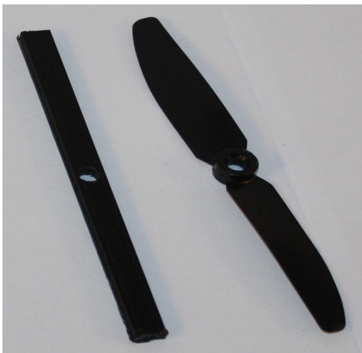
Рисунок 3.8 – Порівняння фактичного гвинта та замітника, який використовувався під час калібрування.
