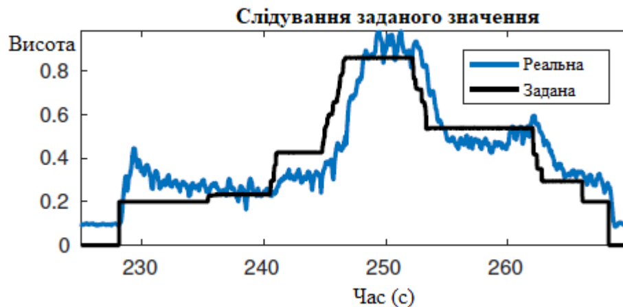
Рис. 6. Виміряна висота при дотриманні якої використовують PID-регулятор
