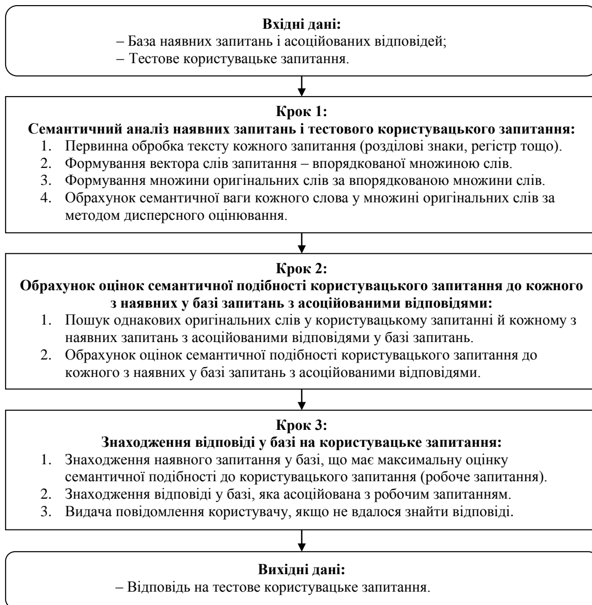
Рисунок 2.2 – Схема методу автоматизованого підбору текстових відповідей на запитання за їх семантичним вмістом
