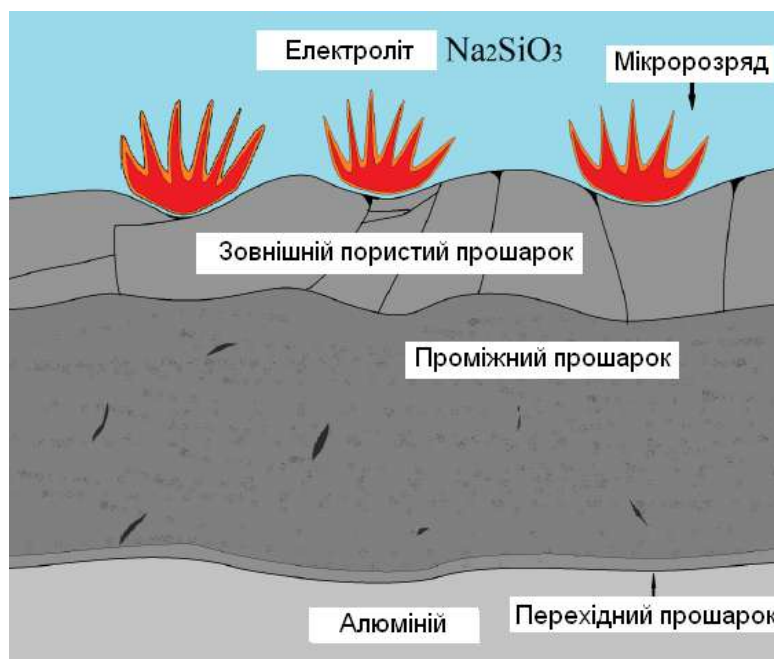
Рисунок 2.1 – Схема процесу ПЕО алюмінію
