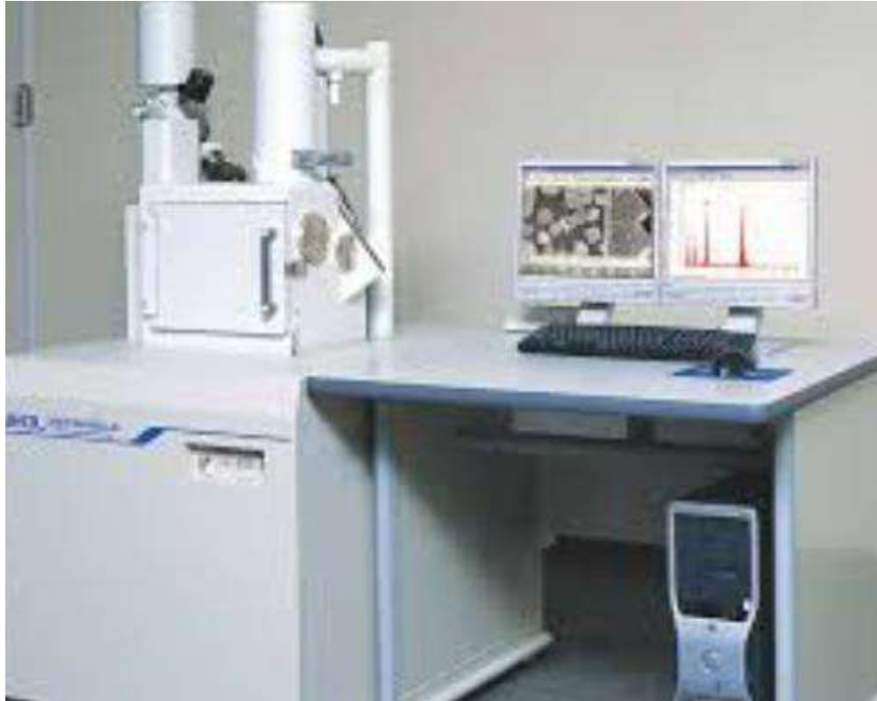
Рисунок 3.2 - SEM установка «JSM-6490LA»
