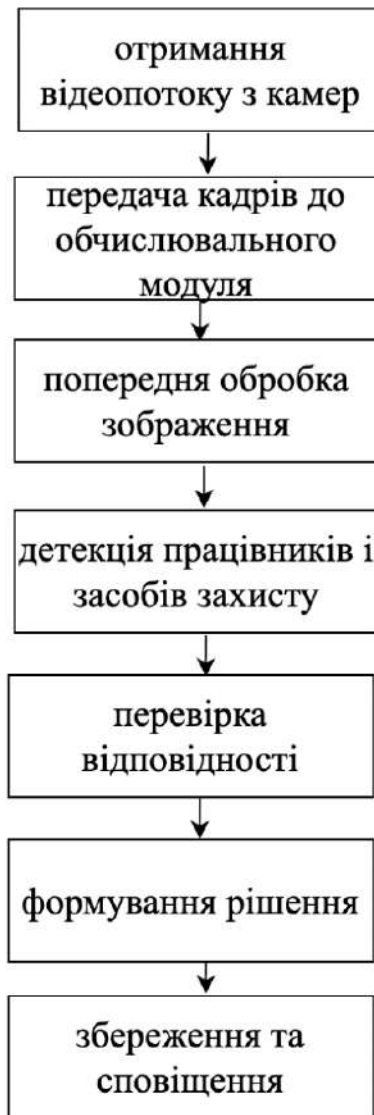
Рисунок 3.2 – Графічне представлення методу функціонування інтелектуальної системи автоматизованого розпізнавання ЗІЗ на виробничих об’єктах
