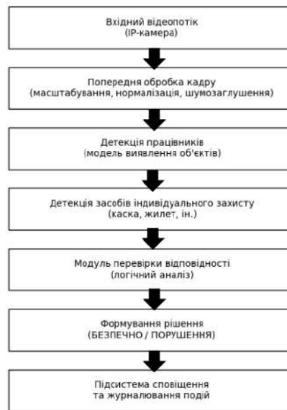
Рисунок 1 – Візуалізація роботи методу автоматичного розпізнавання ЗІЗ на виробничих об'єктах
