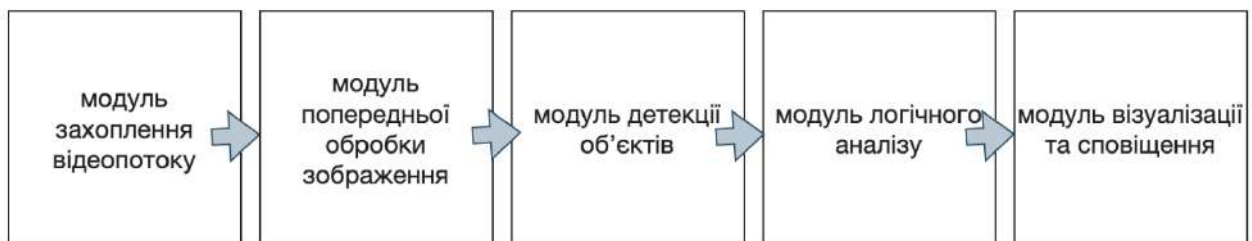
Рисунок 3.8 – Програмна архітектура інтелектуальної комп'ютерної системи автоматичного розпізнавання засобів індивідуального захисту на виробничих об'єктах
