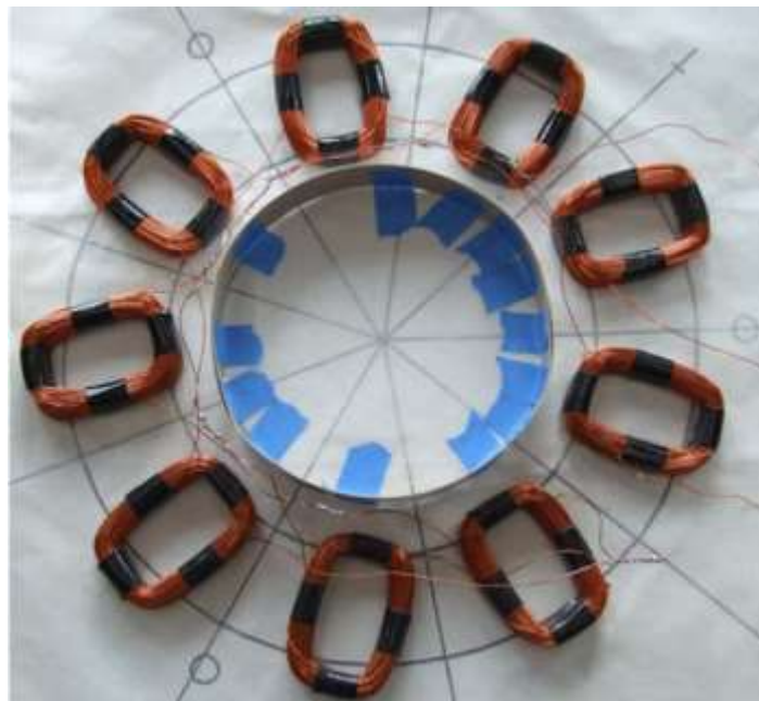
Рисунок 2.10 - Розміщення котушок статора.
