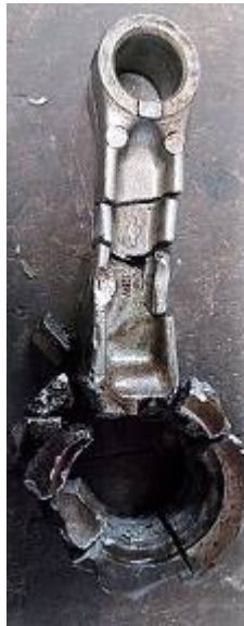
Рисунок 1.7- Руйнування шатуна від гідроудару
