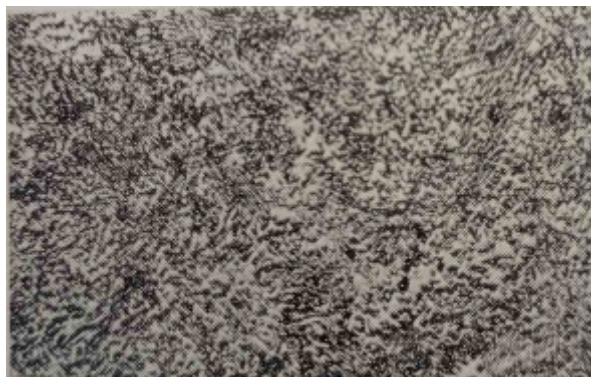
Рисунок 3.21– Структура сталі 40ХГНМ після поліпшення
