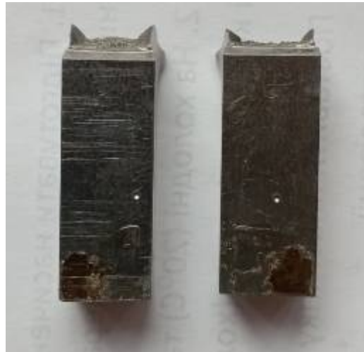
Рисунок 3.22. Зразки для фрактографічного аналізу після випробувань на ударну в'язкість
