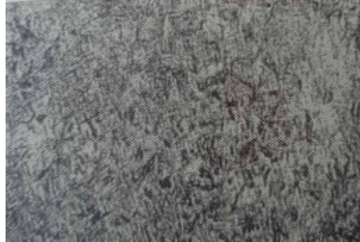
Рисунок 3.18 - Структура сталі після гартування
