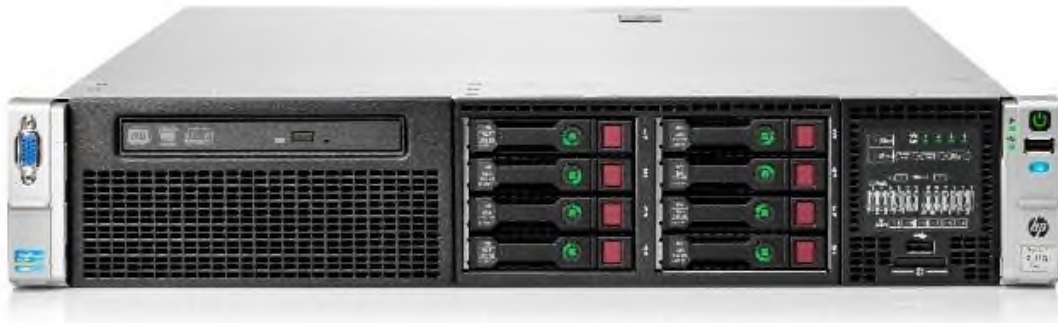
Рисунок 2.3 – Сервер HP ProLiant DL380
