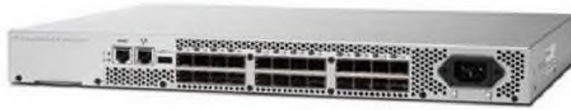
Рисунок 2.6 – Комутатор Brocade 300 FC
