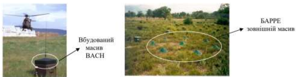
Рисунок 1.3 – Сенсорна система ВАСН/ВАРРЕ та розгорнутий спостережний пост
