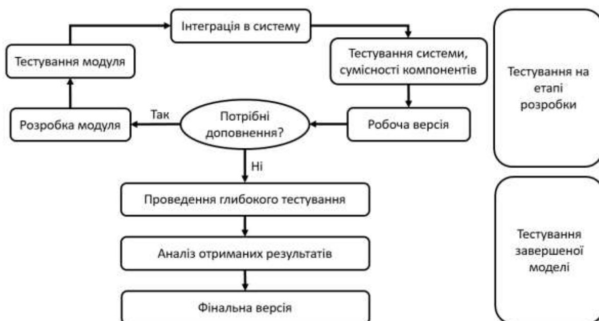
Рисунок 3.1 – Порядок проведення тестування моделі мережі
