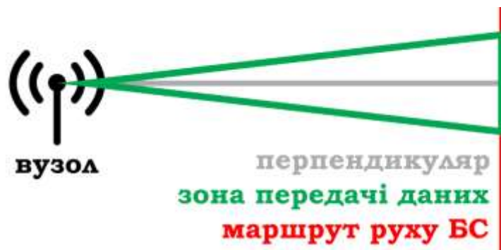
Рисунок 3.7 – Схема передачі даних вузлом по маршруту слідування БС
