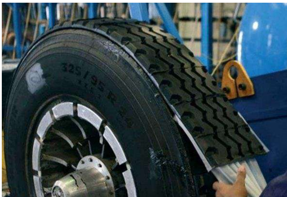
Рисунок – 39. Нанесення шару протекторної стрічки
