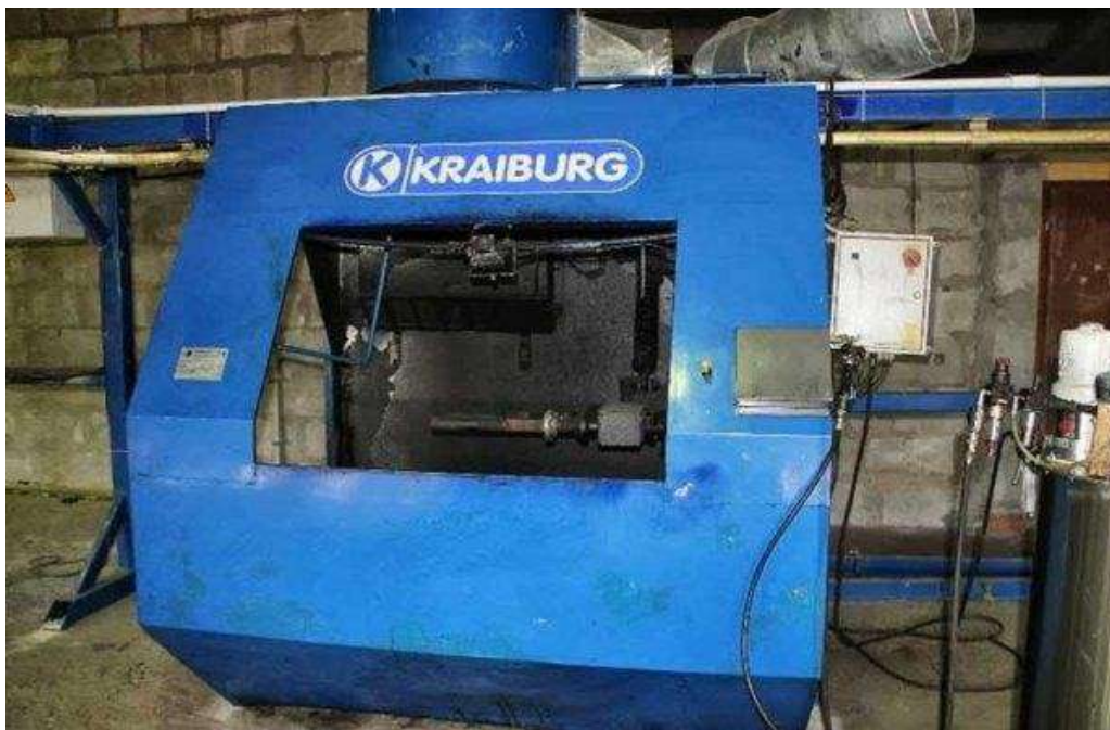
Рисунок – 33. Автоматичний (ручний) верстат для накладання стрічки протектора;
