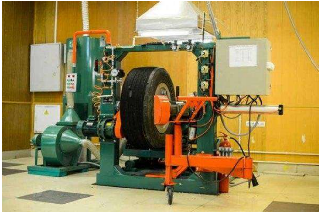
Рисунок – 34. Для екструдування та накладання клею;
