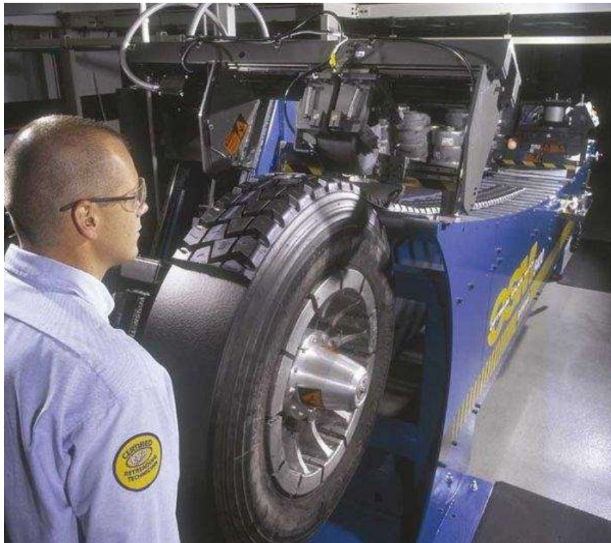
Рисунок – 32. З ЧПУ для шорсткування
