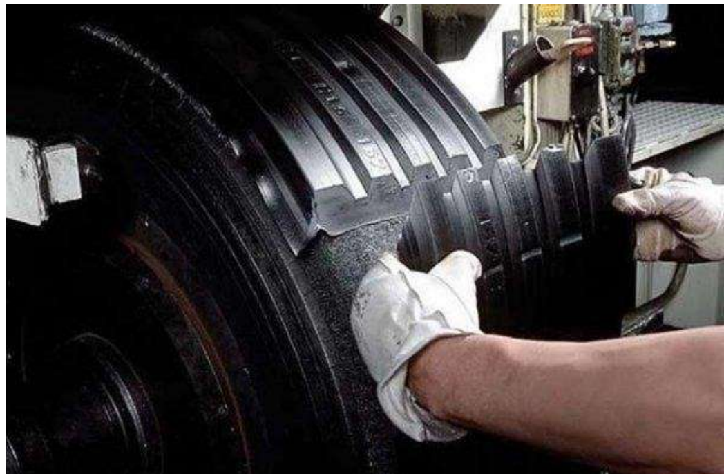
Рисунок – 21. Укладання протекторного шару.
