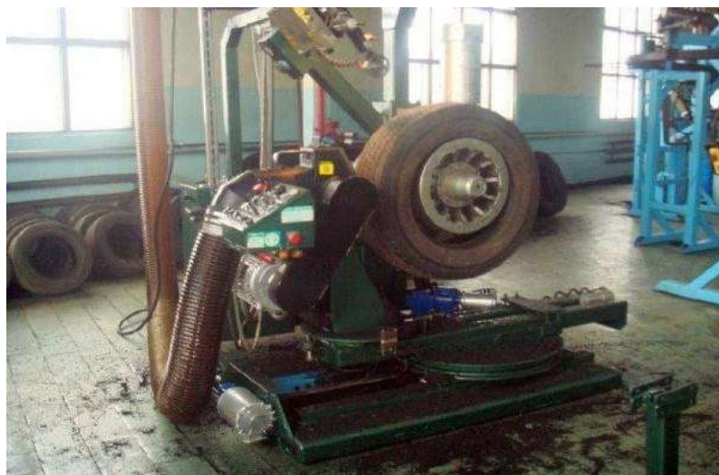
Рисунок – 37. Зняття верхнього шару на спеціальному верстаті.
