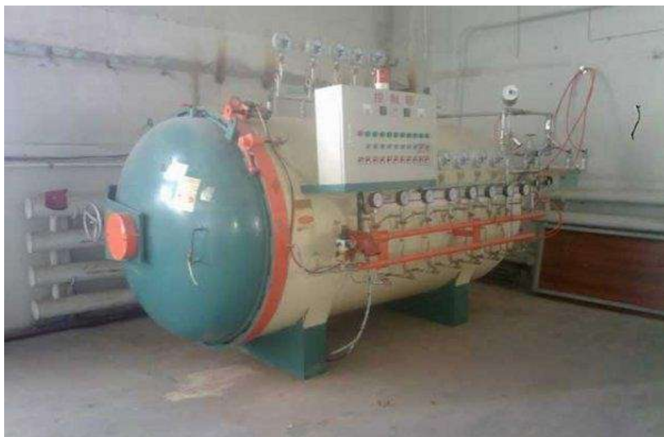
Рисунок. - . 40. Приміщення.вироби в автоклав з підключенням кисневих шлангів.
