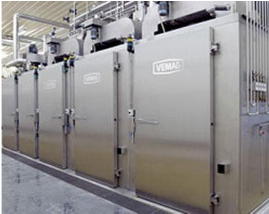
Рисунок 1.8 – Термокамера VEMAG AEROMAT Універсальна камера гарячого копчення та варіння VEMAG
