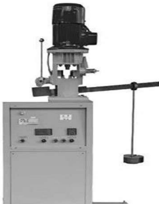
Рисунок 2.2 – Чотирикулькова машина тертя ЧМТ-1
