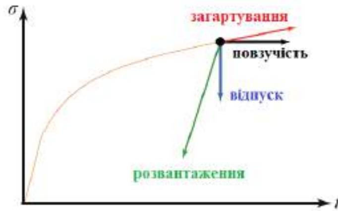
Рисунок 3.1 – Основний принцип реакції матеріалу при навантаженні, утриманні та розвантаженні
