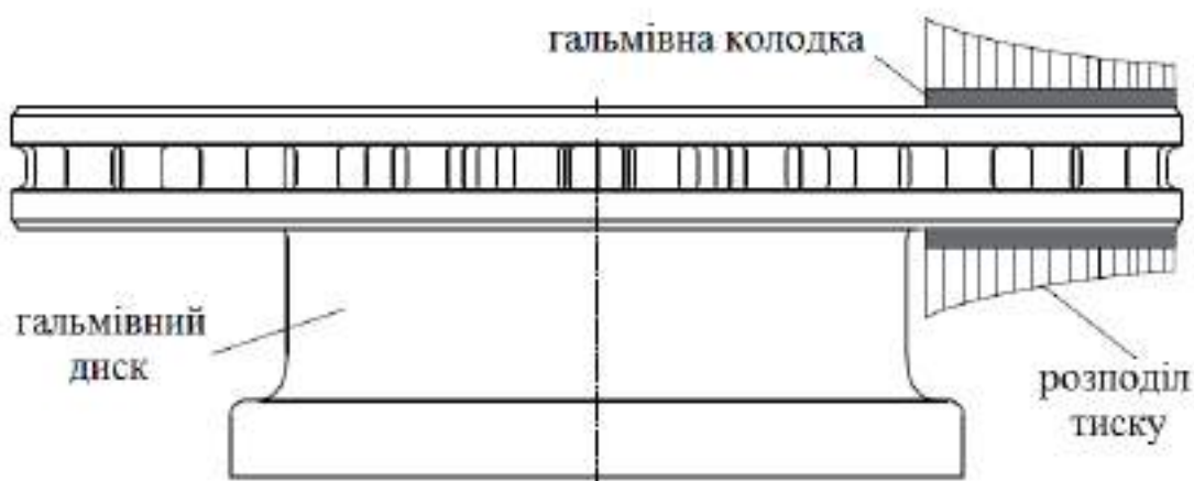
Рисунок 2.2 – Розподіл тиску на гальмівний диск для рівномірного зношування.
