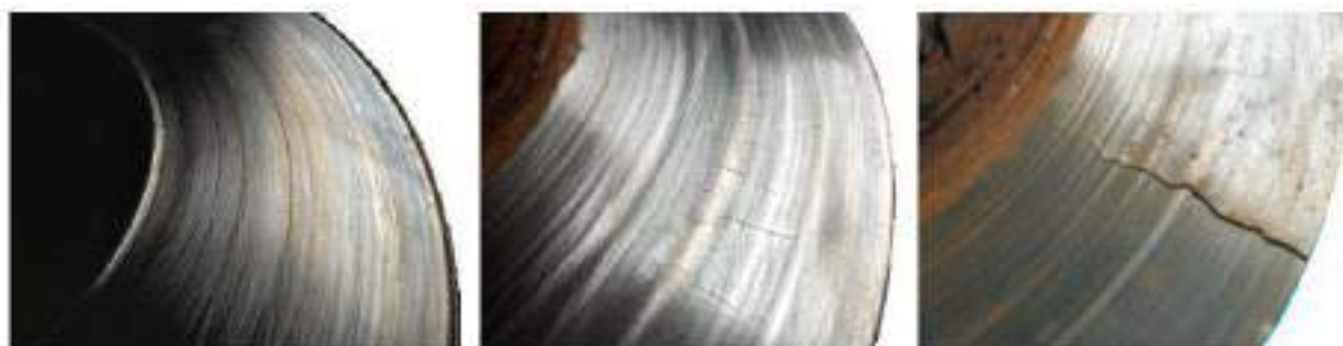
Рисунок 2.1 – Приклади зношування, розтріскування та зламу гальмівних дисків.
