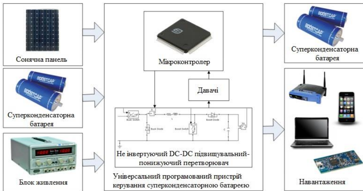
Рисунок 1.1 - Структурна схема універсального пристрою керування суперконденсаторною батареєю [1]
