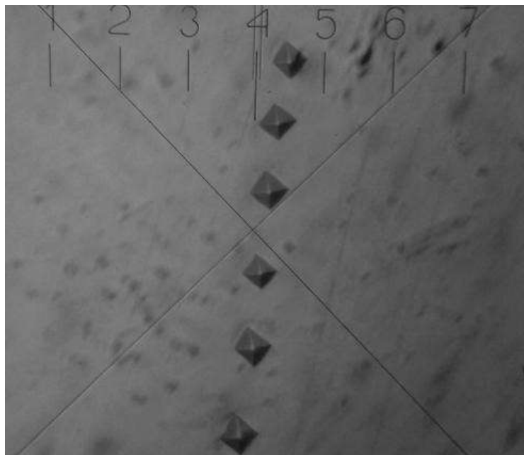
Рис. 3.4. Вимірювання відбитків мікротвердості приладом ПМТ-3 (×500)
